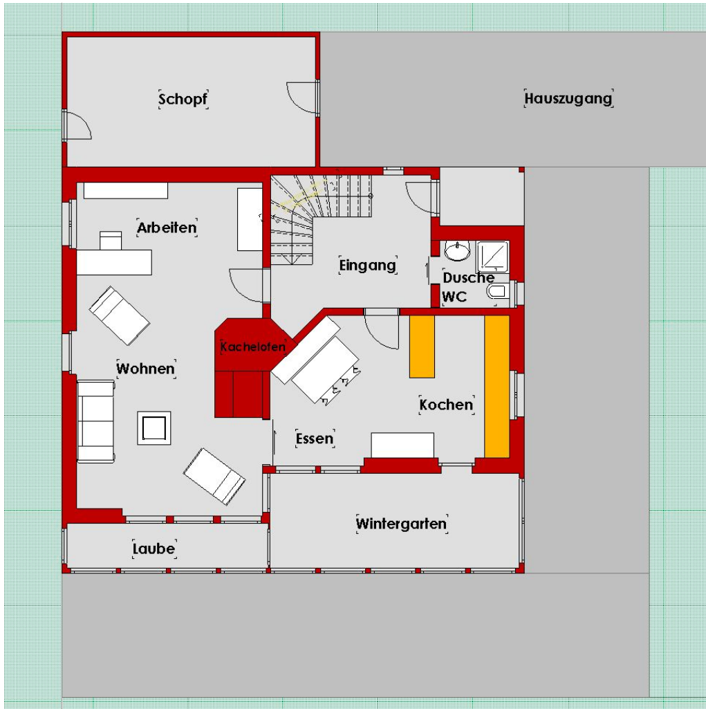
Die Heizwärmequelle ist der Kachelofen. Die Räume gruppieren sich um dieses wärmende Zentrum. (Bild 1)
